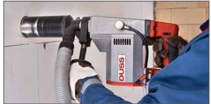
Dosensenken trocken in Kalksandstein mit Staubabsaugung
