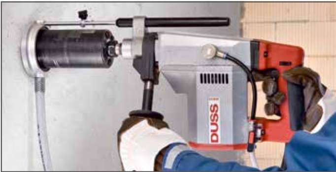
Dosensenken nass in Beton mit Wasserabsaugung
