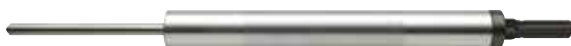
Schnellzentrierer für schnelles, handgeführtes Anbohren bis Ø 152 mm. Die federnde Zentrierspitze weicht beim Anbohren zurück. Eine Zentrierbohrung ist nicht erforderlich. für Bohrkronen mit einer Arbeitslänge von 250 mm bis 300 mm Bestell-Nr. SZ für Bohrkronen mit einer Arbeitslänge von 400 mm bis 450 mm Bestell-Nr. SZ 4 für Bohrkronen mit einer Arbeitslänge von 100 mm bis 163 mm Bestell-Nr. SZ 150
