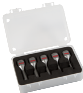
Diamantbohrkronen LDM Set 1 5-teilig, Bohr-Ø 2x 6, 8, 10, 12 mm, für Winkelschleifer, M14 innen, mit Kühlwachs Bestell-Nr. LDM Set 1
